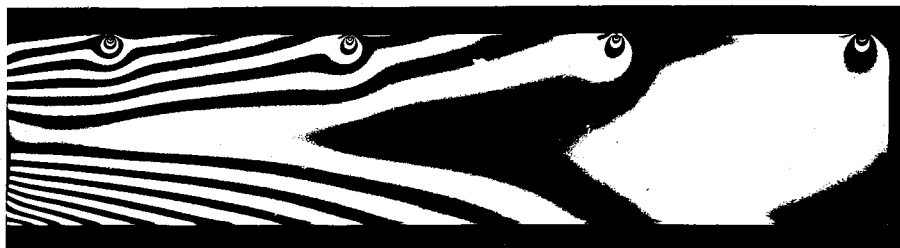
Abb. 6d: Isochromaten eines einseitig aufgehängten und an vier Stellen belasteten Balkens.
